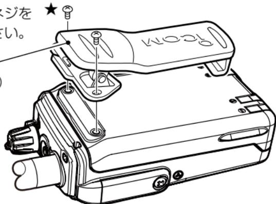
※ ネジの長さは、ベルトクリップの種類(☞P55)によって異なります。
