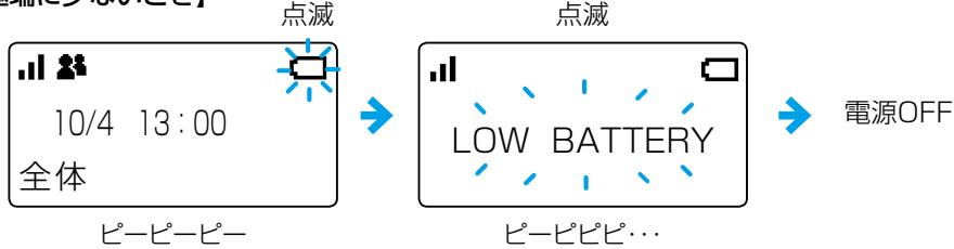
※残量表示が「
