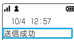
※送信先が個別の場合だけ、表示部に送信結果(送信成功/送信失敗)が表示されます。
